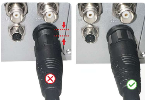
Figuur 5. Installatie celkabel
